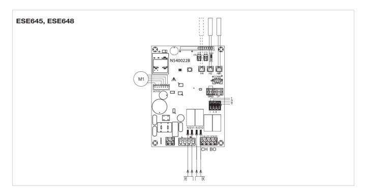
I 4 morsetti (rif. A) destinati alla connessione del controllo a muro EDA/EDB649 - EWG/EWW649 accettano cavi rigidi o flessibili con sezione da 0,2 a 1 mm² (0,75 mm² se si collegano 2 conduttori nello stesso morsetto), mentre se gli stessi sono dotati di capocorda con collare in plastica la sezione massima è di 0,75 mm².
